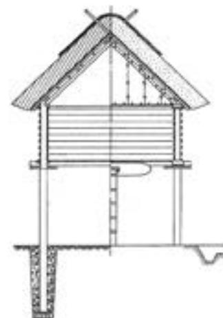
^ Рис. 3. Конструктивно-пространственная схема такаюка.
